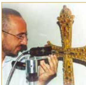
Renishaw的RP10小型光纤探头用于宝石原位分析
